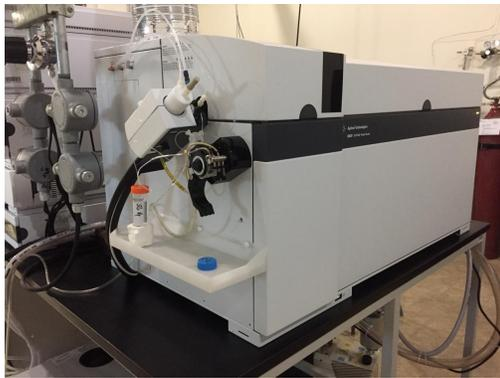
Espectrómetro de masas triple cuadrupolo con plasma de acoplamiento inductivo, ICP-QQQ 8800 Agilent.
