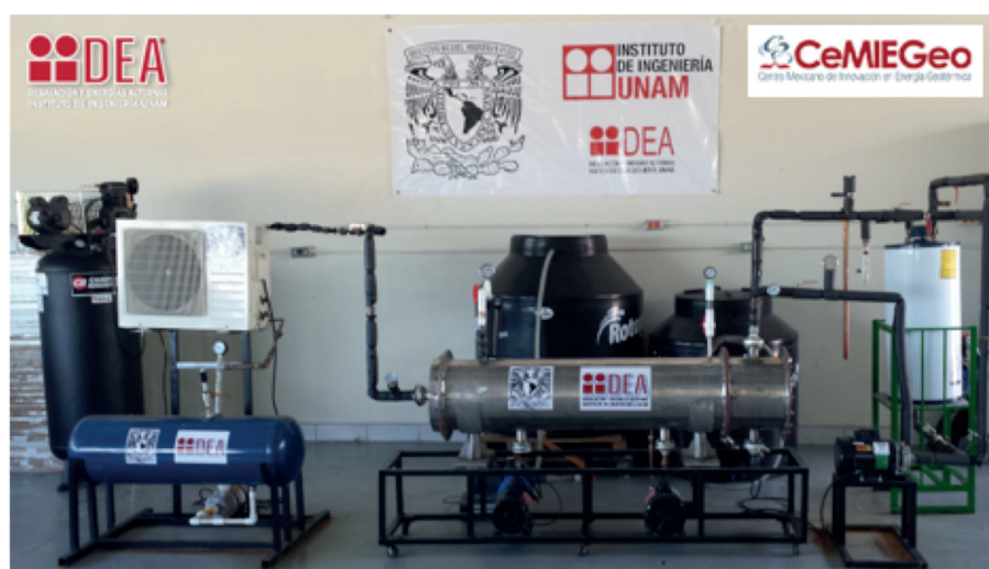
Figura 20. Prototipo de la planta desaladora de 3 m³/día. Aviña et al., IINGEN, UNAM.
